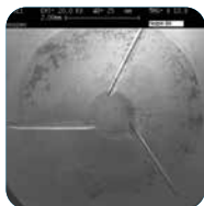
Tangentialschlitze der Düse in Makroaufnahme mit Clean up
